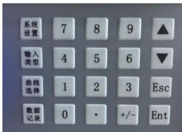
图 4 4 行 5 列密封式薄膜键盘
